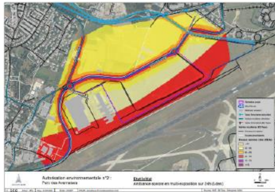
Figure 5: Cartographie de l'environnement sonore toutes sources cumulées en Lden(24h) (source : page 172 volet D1 - Description du projet et état initial).
